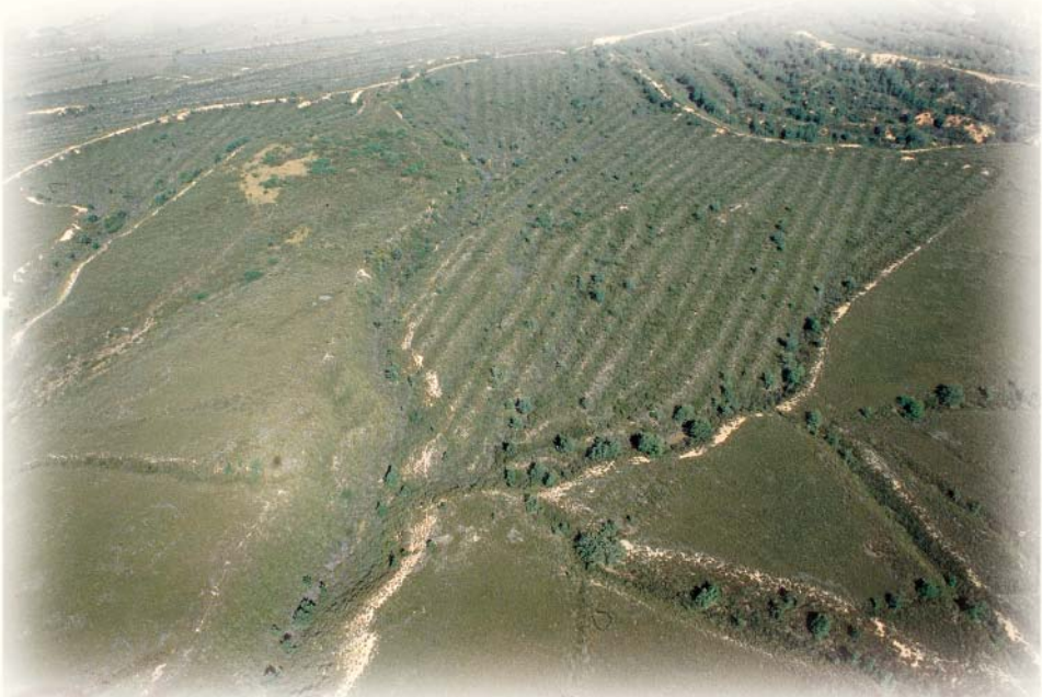
Peines o zanjás canal
